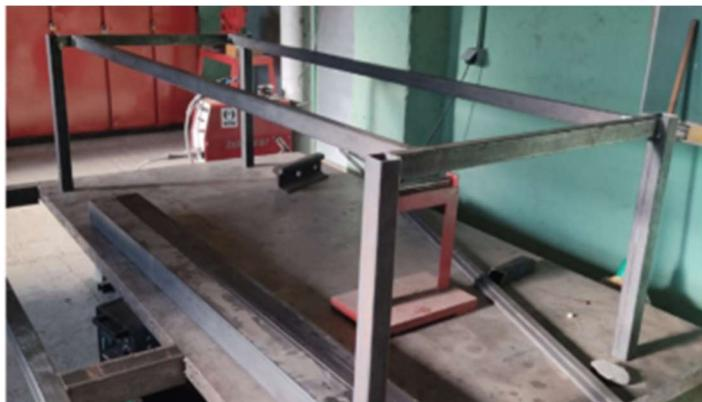
Tijekom praktične nastave učenici 2.razreda zanimanja strojobravar, pod vodstvom nastavnika Ivana Stanića i Branka Stiplošeka, izradili su metalnu konstrukciju za stolove. Nakon postupka kabliranja i montaže nove računalne mreže, ukazala se potreba za uređenjem kabineta informatike te novi razmještajem postojećih i izradu novih stolova za potrebe nastave informatike i fakultativne nastave
