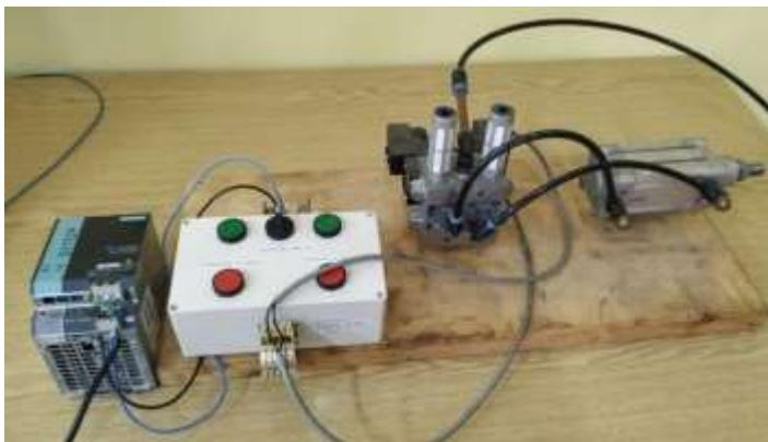
Ovih dana završen je projekt izrade nastavnog sredstva koji će se koristi u nastavi koja se provodi za učenike strojarske grupe predmeta. Radi se o uređaju za elektromagnetsko upravljanje pneumatskim aktuatorima (cilindrima). Uređaj će biti korišten uz postojeću didaktičku opremu renomirane tvrtke SMC, koja se koristi pri obradi nastavnih cjelina vezanih uz pneumatiku, koja je jedan
