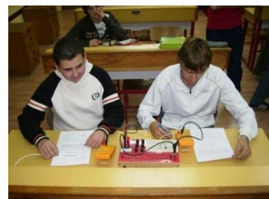
Eksperimentalne pločice su sa rasterom 2,54 mm pa se integrirani sklopovi, tranzistori, otpornici, kondenzatori i ostali elementi direktno ubadaju. Za spajanje ubodnih utičnica na pločici trebaju puni bakreni vodiči promjera 0,4 mm s izolacijom u različitim bojama. Vodiči su duljine od 15, 50, 100 i 200 mm sa skinutom izolacijom na krajevima od 5 mm.
