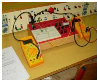
Uređaj je namijenjen sastavljanju raznih elektroničkih sklopova kao i provjeri aktivnih i pasivnih elemenata, a sve u sklopu nastavnih predmeta u elektrotehničkoj struci (Radioničke vježbe, Osnove elektrotehnike, Analogni i digitalni sklopovi, Elektronički sklopovi, Elektrotehnički materijali i komponente, Energetska elektronika itd.). Omogućava brzu izmjenu pojedinih dijelova sklopa i skraćuje vrijeme izvođenja vježbe.
